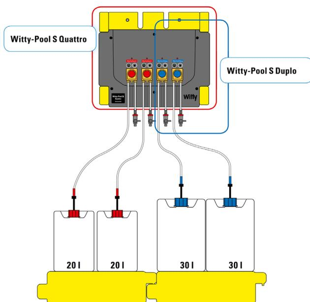
Optimal abgesichert bei der Wasseraufbereitung im Schwimmbad: Mit Witty-Pool S Duplo und Quattro.
